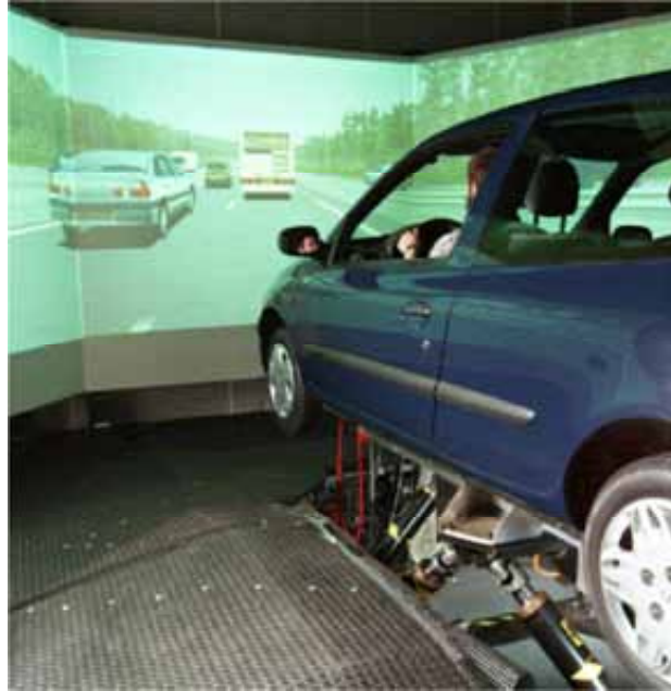
ภาพที่ 2-9 การทดสอบโดยใช้เครื่องจำลองการขับซีรอนด์[8]
