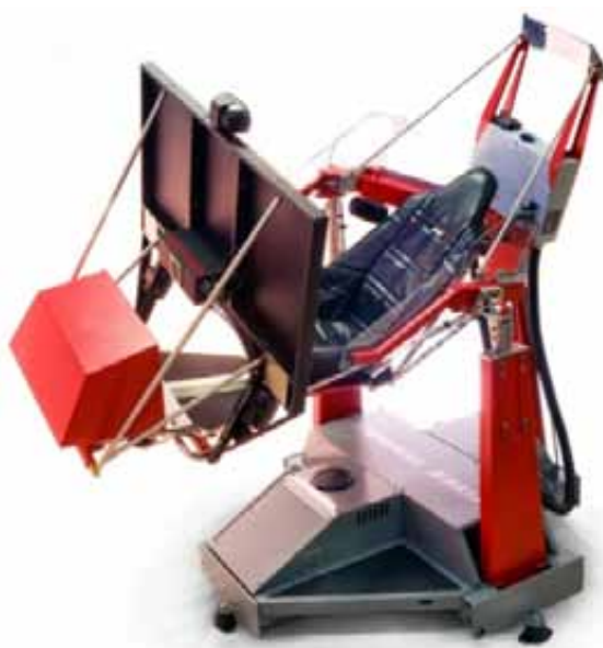
ภาพที่ 2-12 เครื่องจำลองการขับขี่ใน 3 ระดับขั้นเสรี โดยใช้อุปกรณ์ขับเคลื่อนเป็นอุปกรณ์ขับ[19]
