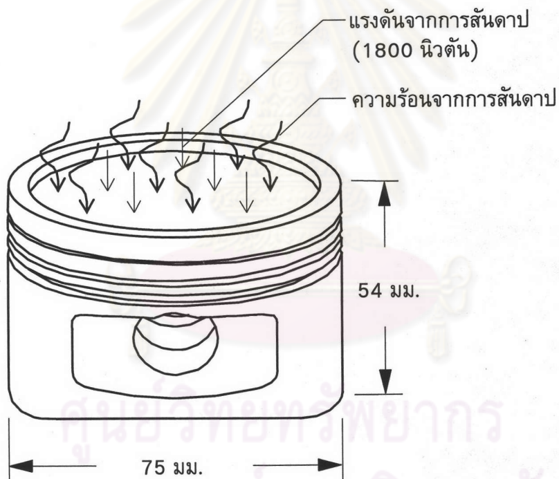
รูปที่ 5.53 แสดงรูปร่างของลูกสูบเครื่องยนต์
