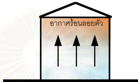
รูปที่ 4.9 แนวคิดพื้นที่เปิดโล่ง ฝ้าเพดานสูงกว่าปกติ
