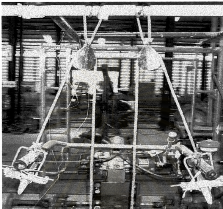
รูปที่ 5.19 ชุดทดลองวัดแรงบีบคลัตช์บังคับลิ้นว
