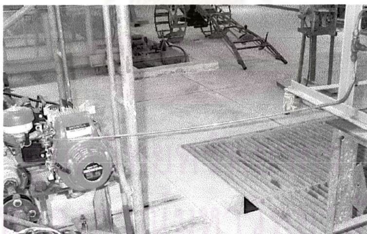
รูปที่ 5.16 การต่อสายยางจากชุดวัดอัตราการไหลของน้ำมันเชื้อเพลิงเข้ากับเครื่องยนต์
