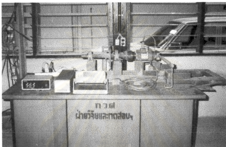
รูปที่ 5.3 การปรับเทียบ Torque transducer สำหรับวัดแรงบิดเครื่องยนต์
