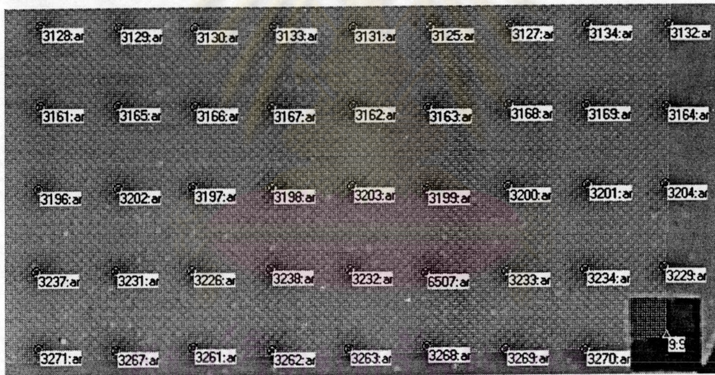
รูปภาพที่ 3.26 ภาพแสดงการอ้างอิงจุดรั้วร่วมบนภาพถ่ายด้วยวิธีอัตโนมัติ
