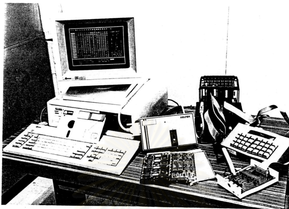
รูปที่ 6.2 แสดงองค์ประกอบทั้งหมดของระบบพัฒนาไมโครโปรเซสเซอร์ระดับบอร์ด
