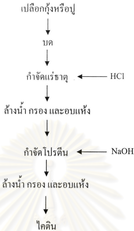
รูปที่ 2.2 ขั้นตอนทั่วไปของกระบวนการเตรียมไคติน
