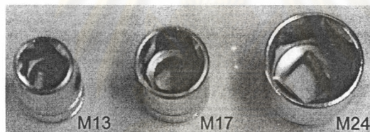
รูปที่ 4.3 ประแจบ็อก เบอร์ M13 M17 และ M24
