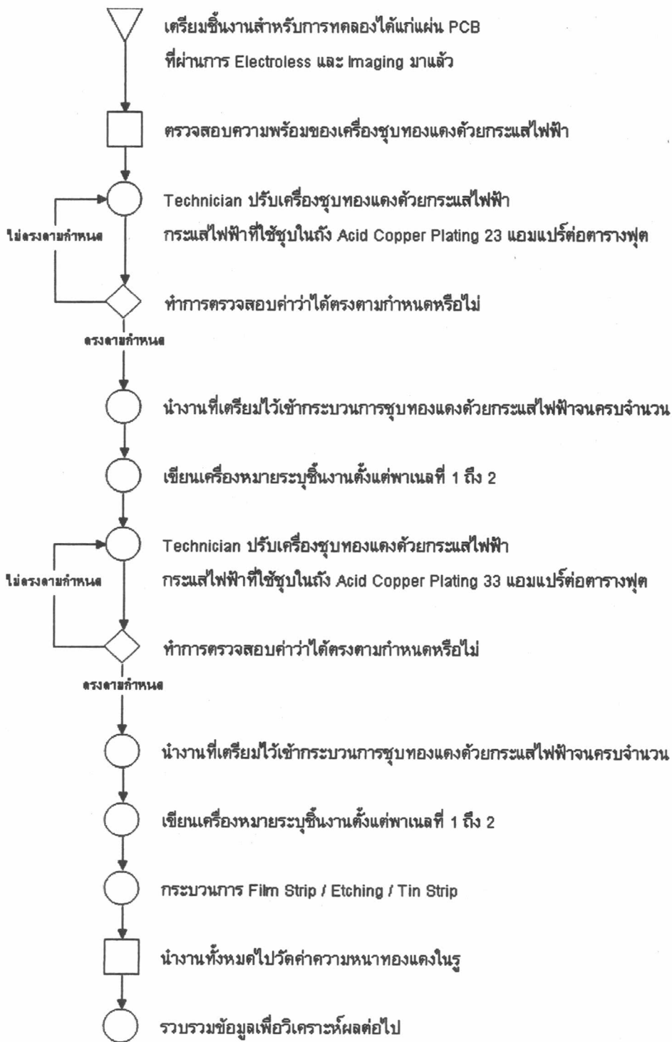
รูปที่ 6.5 ขั้นตอนการทดลองสำหรับกระแสไฟฟ้าที่ใช้ในการชุบในถัง Acid Copper Plating
