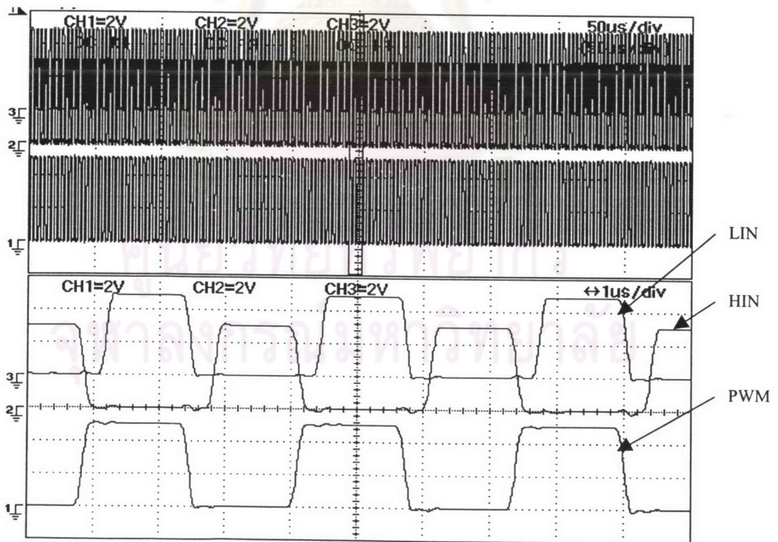
รูปที่ 3.14 สัญญาณ PWM ที่ได้จาก Optocoupler และสัญญาณที่ได้จากวงจรสร้างเวลาพัก (HIN,LIN)
