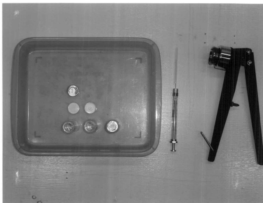
รูปที่ 3.6 อุปกรณ์และเครื่องมือสำหรับการวิเคราะห์ด้วยเทคนิคแก๊สโครมาโทกราฟีแบบเฮดสเปต
