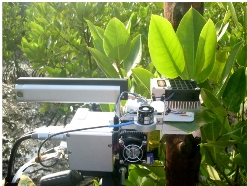
ภาพที่ 3.11 เครื่องวัดอัตราการสังเคราะห์ด้วยแสง (ก) portable photosynthesis system (LI-6400, LI-COR, Lincoln, Nebraska, USA) และ (ข) leaf chamber
