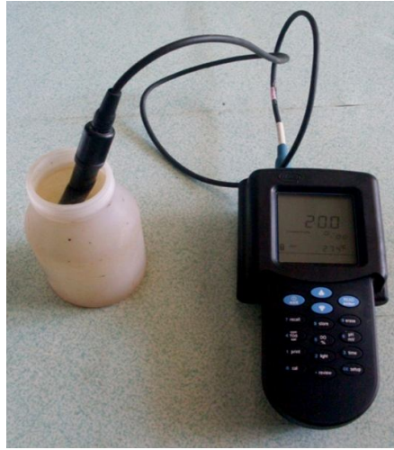
ภาพที่ 3.12 ศึกษาคุณสมบัติของน้ำในดินด้วย ด้วย Portable Multiparameter Meter (sessION 156, Hach Company, USA)
