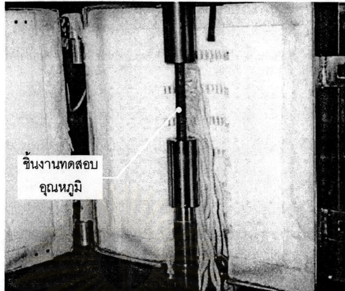
รูปที่ 6.20 ลักษณะการติดตั้งชั้นงานทดสอบกับเครื่องทดสอบความคืบเพื่อวัดอุณหภูมิ
