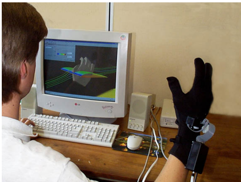
ภาพที่ 2.3 ความเป็นจริงเสมือนแบบผ่านจอภาพ (Non-immersive VR หรือ Desktop VR)
