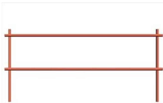
ภาพที่ 3.2 ราวกันตกแบบแนวนอน ราวบนและราวกลาง
