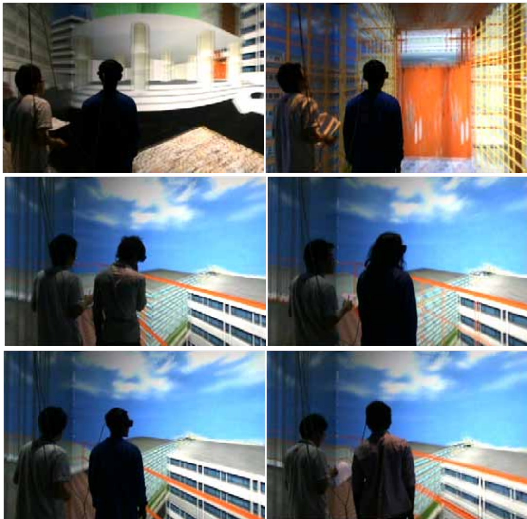
ภาพที่ 4.25 การทดสอบความรู้สึกของคนงานก่อสร้างด้วยเครื่องมือจำลองสภาพแวดล้อมเสมือนจริง
