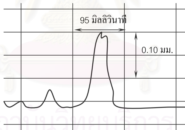
รูปที่ 3.3 ลักษณะสัญญาณค่าการหลุดตัวจากเครื่อง FWD และล้อรถหนักที่สัญจรบนถนนเมื่อพิจารณาเทียบกับเวลา
