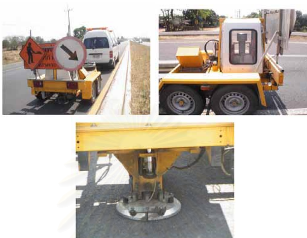
รูปที่ 2.1 เครื่องทดสอบชนิด falling weight deflectometer (FWD)
