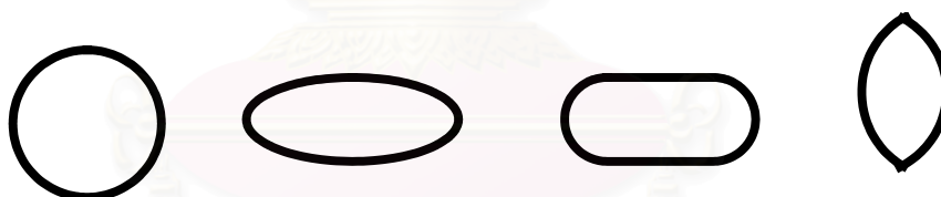
รูปที่ 2.26 ภาพพื้นที่หน้าตัดของเส้นด้ายในรูปแบบต่างๆ (Kemp, 1958)
