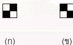
รูปที่ 2.10 ลายขัด (สังเกตว่าทั้งสองภาพจะให้ผ้าที่เหมือนกัน)
