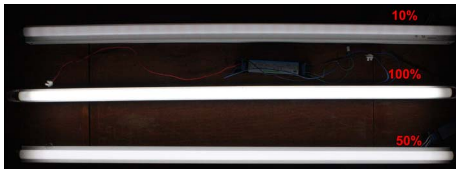
ภาพที่ 5-12 การควบคุมระดับการส่องสว่างแบบรายตัว
