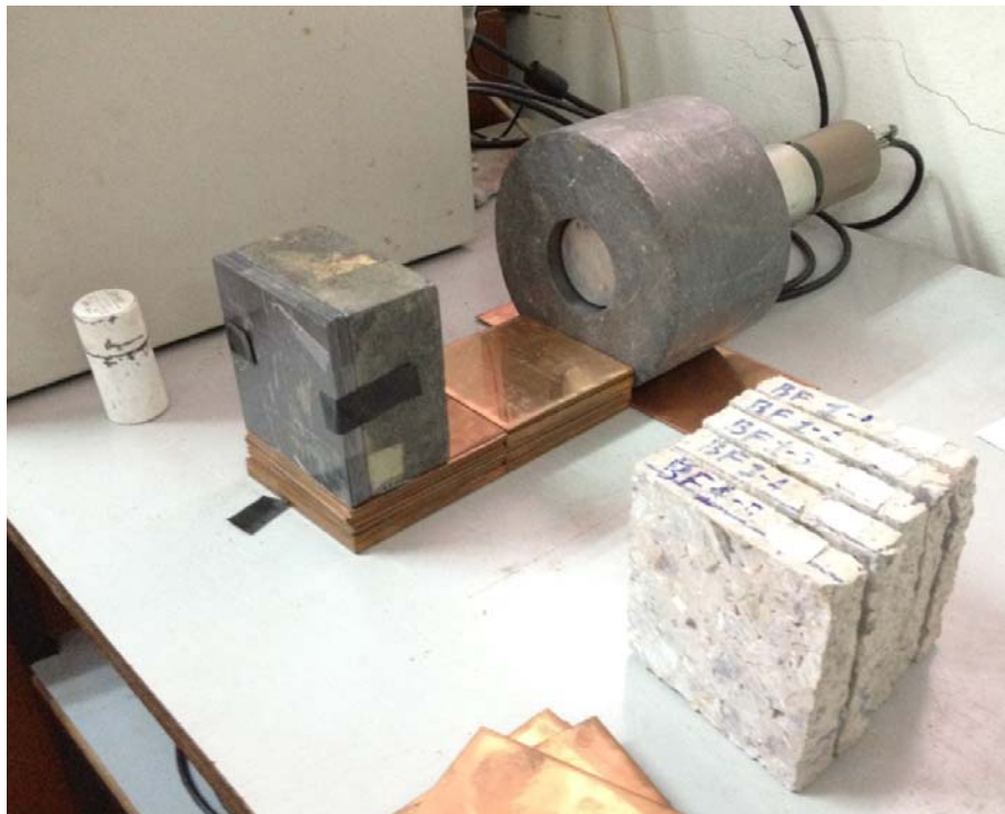
ภาพที่ 4.20 แสดงชุดอุปกรณ์การทดสอบรังสีแกมมา
