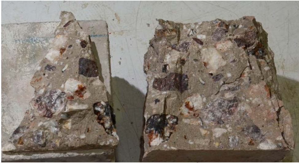
ภาพที่ 4.5 แสดงตัวอย่างก้อนคอนกรีตมวลหนัก ที่โดนกดแตกโดย UTM
