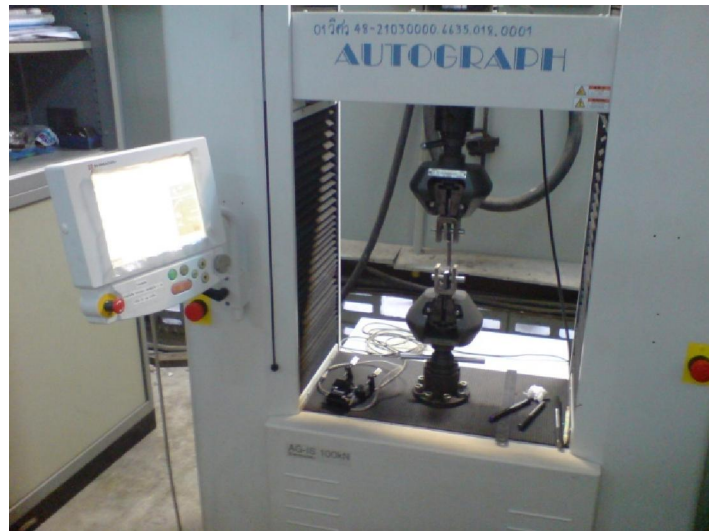
รูปที่ ๒ เครื่องทดสอบแรงดึง universal tensile test machine
