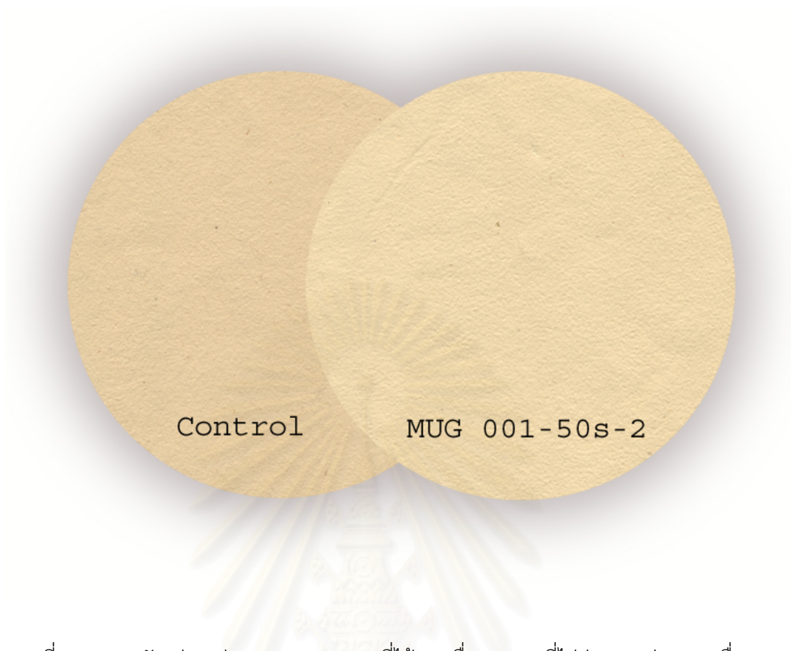
ภาพที่ 14 ตัวอย่างแผ่นทดสอบมาตรฐานที่ได้จากเชื้อกระดาษที่ไม่ผ่านการฟอกและเชื้อกระดาษที่ผ่านการฟอกด้วย crude enzyme ของ MUG 001-50S-2
