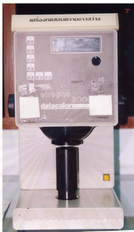
ภาพที่ 17 เครื่องวัดค่าความขาวสว่างของเยื่อ
