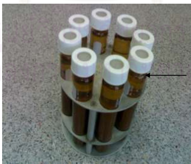
รูปที่ 3.2 ตัวอย่างฟางข้าวที่เติมกรดอะคริลิกในสารละลายน้ำก่อนนำไปฉายรังสีแกมมา
