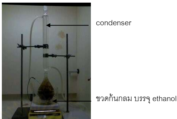
รูปที่ 3.1 การต่ออุปกรณ์ชุดต้มแบบรีฟลักซ์สำหรับเตรียมฟางข้าว
