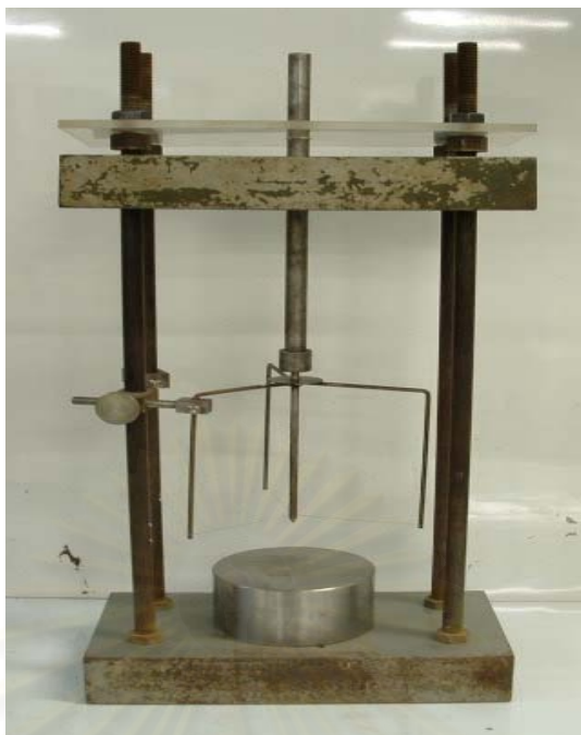
รูปที่ 3.7 เครื่องมือตัดแบ่งตัวอย่างดินเหนียวสร้างใหม่
