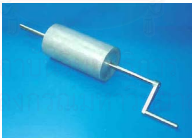
รูปที่ 4.3 แม่แบบอลูมิเนียมที่ใช้ในการผลิต Rubber Membrane
