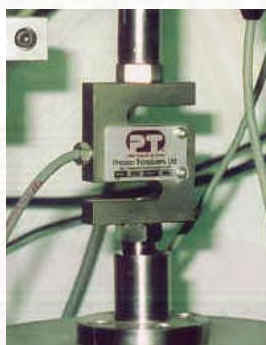
รูปที่ ค-6 Load Cell สำหรับวัดแรงรวมต้านทานปลายกรวย
