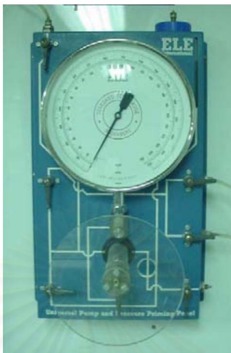
รูปที่ ค-5 Pressure Gauge สำหรับควบคุมแรงดันน้ำแบบ Manual
