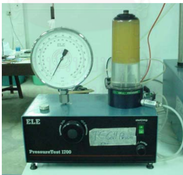
รูปที่ ค-4 Hydraulic Oil Pump สำหรับปรับเปลี่ยนแรงดันน้ำ
