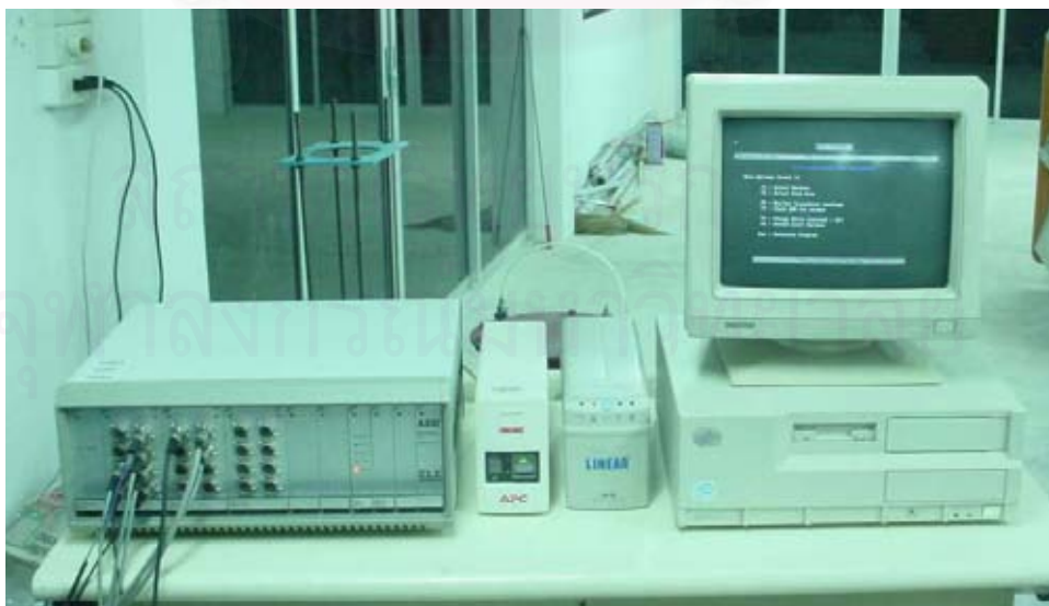
รูปที่ ค-2 เครื่องคอมพิวเตอร์และ ADU สำหรับเก็บข้อมูลการทดสอบ
