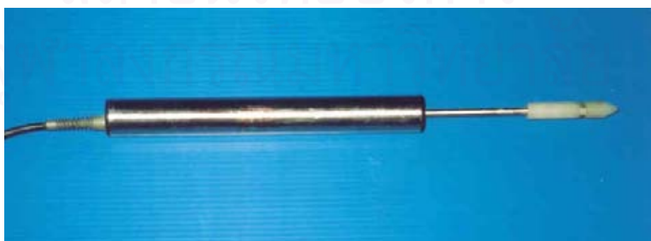
รูปที่ ก-10 LVDT สำหรับวัดการเคลื่อนที่ในแนวตั้ง
