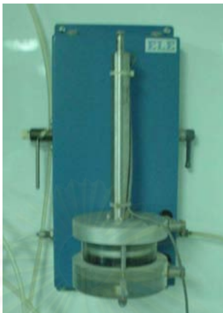
รูปที่ ก-8 Volume Change Unit สำหรับวัดปริมาตรน้ำที่เปลี่ยนแปลงไปในโพรงดิน
