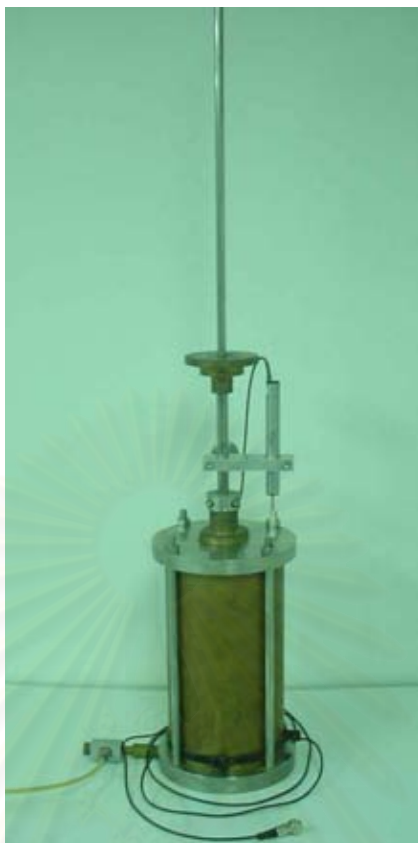
รูปที่ จ-1 เครื่องมือ Reconstituted Consolidometer No.1 (วิโรจน์, 2546)
