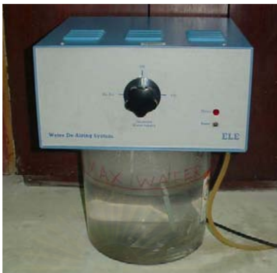
รูปที่ ค-11 Deaired Water Apparatus สำหรับผลิต Deaired Water ที่ใช้ในการทดสอบ
