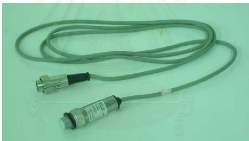
รูปที่ ก-9 Pressure Transducer สำหรับวัดแรงดันน้ำในโพรงดิน
