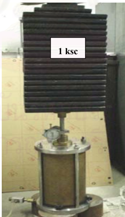
รูปที่ 3.5 การทดสอบการอัดตัวคายน้ำของดินเหลว
