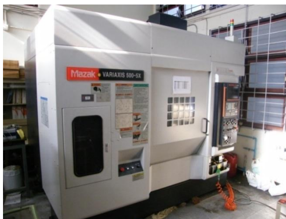
ภาพที่ 3.3 เครื่องซีเอ็นซีแมชชีนนิ่งเซ็นเตอร์ชนิด 5 แกน รุ่น Variaxis 500-5X
