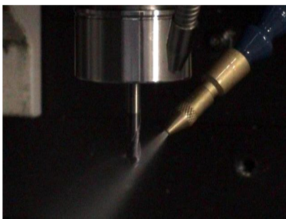
ภาพที่ 3.8 ลักษณะการตัดแบบใช้ลมเป่า
