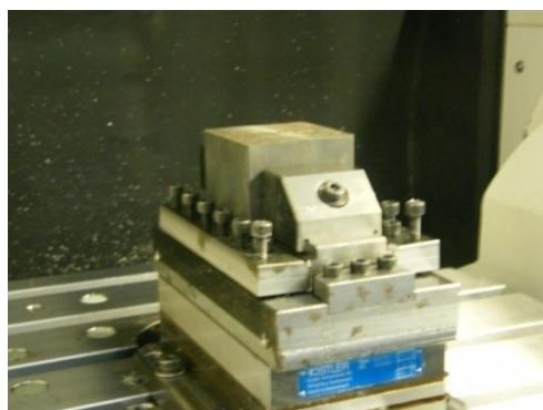
ภาพที่ 3.11 การเตรียมชิ้นงานและชิ้นงานที่ผ่านการปาดหน้าเรียบร้อยแล้ว
