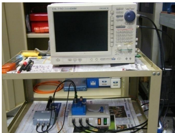
ภาพที่ 3.10 การเชื่อมต่อสายไดนาโมวัดแรงกับเครื่องขยายสัญญาณและเครื่องออสซิลโลสโคป
