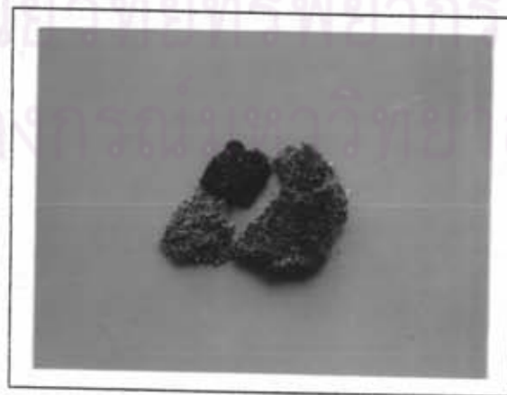
รูปที่ 5.2 ลักษณะการจับตัวกันของแกลบที่เป็นอุปสรรคต่อการเกิดสภาวะฟลูอิดไรเซชัน
