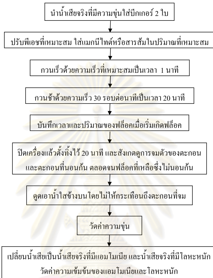
รูปที่ 3.6 แผนผังการทดลองหาประสิทธิภาพในการบำบัดของน้ำเสียจริง
