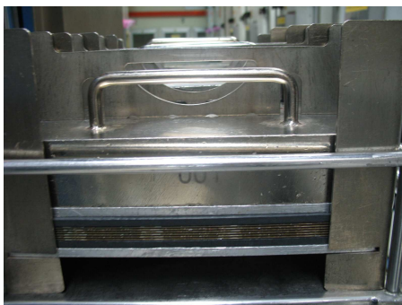
ภาพที่ 5.2 สตริปงานที่ถูกใส่อยู่ในแมกกาซีนแบบซ้อน และถูกทับด้วยตุ้มน้ำหนักก่อนนำเข้าอบที่กระบวนการ Package cure
