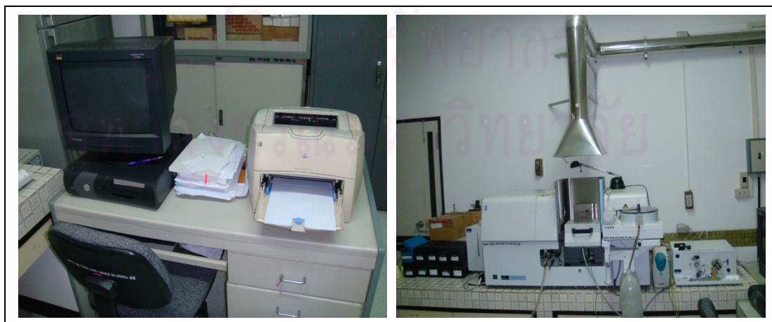
รูปที่ ค6 เครื่องอะตอมมิคแอบซอร์ชันสเปกโตรมิเตอร์ (atomic absorption spectrometer; AAS)
