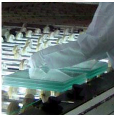
ภาพที่ 3.1 การจัดเรียงแผ่นกระจกและแผ่นฟิล์ม
