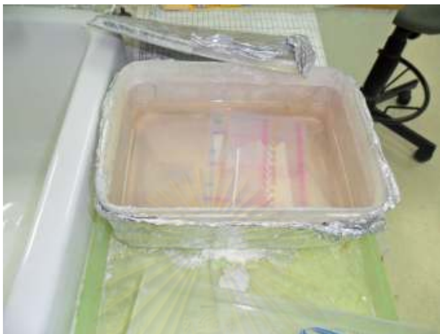
ภาพที่ 7 ตัวอย่างจะถูกนำมาหยุดในช่องหลุมก่อนที่จะนำมาผ่านกระแสไฟฟ้า
