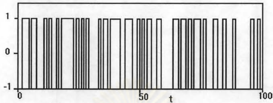
รูปที่ 3.6 สัญญาณอินพุตแบบซุโดแรนดอมมีไบนารีซีเคว้นซ์ (Pseudorandom binary sequence , PRBS)
