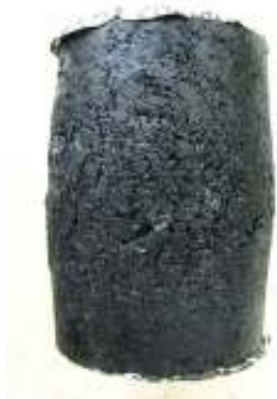
ตัวอย่างแอสฟัลติกคอนกรีต AC60/70 อุณหภูมิ 25°C อัตราความเครียด = 0.0056 ต่อวินาที
