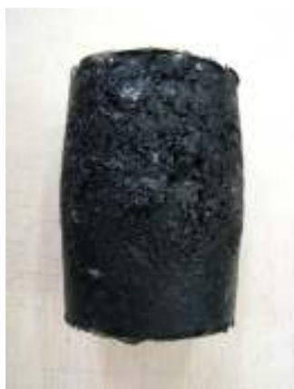
ตัวอย่างแอสฟัลติกคอนกรีต AC40/50 อุณหภูมิ 25°C อัตราความเครียด = 0.0056 ต่อวินาที
