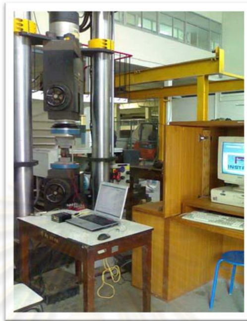
รูปที่ 3.3 เครื่องมือทดสอบ Universal Testing Machine (Instron UTM-1.2MN)
