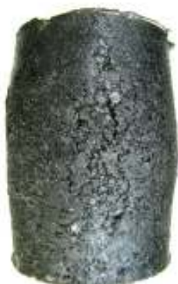
ตัวอย่างแอสฟัลติกคอนกรีต AC40/50 อุณหภูมิ 40°C อัตราความเครียด = 0.0056 ต่อวินาที
