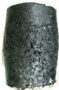
ตัวอย่างแอสฟัลติกคอนกรีต AC40/50 อุณหภูมิ 40°C อัตราความเครียด = 0.0167 ต่อวินาที
