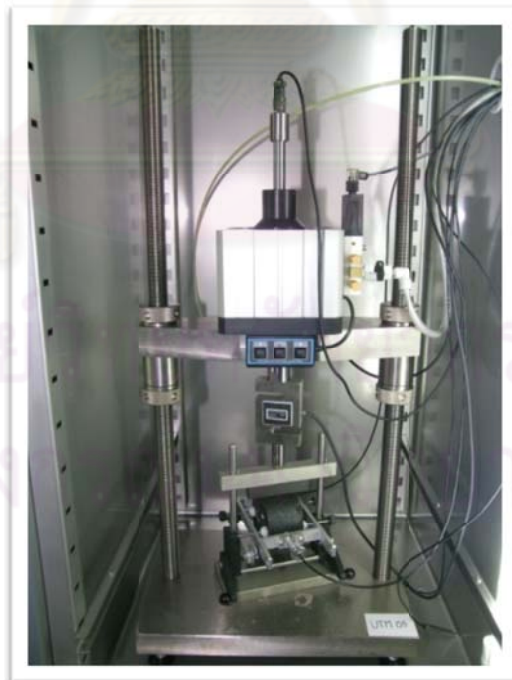
รูปที่ 3.6 รูปแบบการติดตั้งตัวอย่างสำหรับทดสอบโมดูลัสคืนตัว
