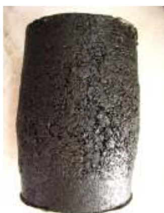
ตัวอย่างแอสฟัลติกคอนกรีต AC60/70 อุณหภูมิ 55°C อัตราความเครียด = 0.0006 ต่อวินาที
