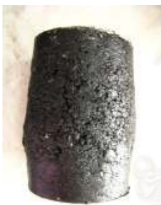
ตัวอย่างแอสฟัลติกคอนกรีต AC40/50 อุณหภูมิ 55°C อัตราความเครียด = 0.0167 ต่อวินาที
