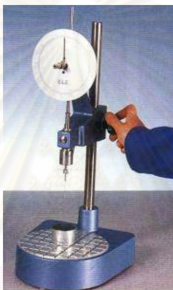
รูปที่ 2.16 เครื่องมือการทดสอบค่าการเจาะลึก ( http://www.jazzar.com )
