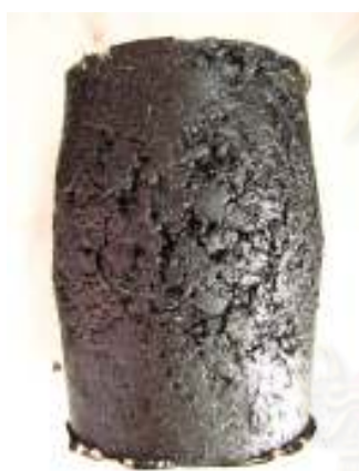
ตัวอย่างแอสฟัลติกคอนกรีต AC40/50 อุณหภูมิ 55°C อัตราความเครียด = 0.0017 ต่อวินาที
