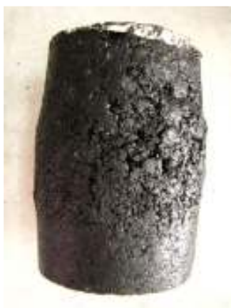
ตัวอย่างแอสฟัลติกคอนกรีต AC40/50 อุณหภูมิ 55°C อัตราความเครียด = 0.0056 ต่อวินาที
