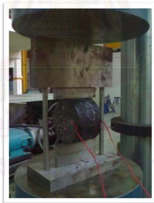
รูปที่ 3.4 รูปแบบการทดสอบแรงดึงทางอ้อมและการติดตั้งเกจวัดความเครียด
