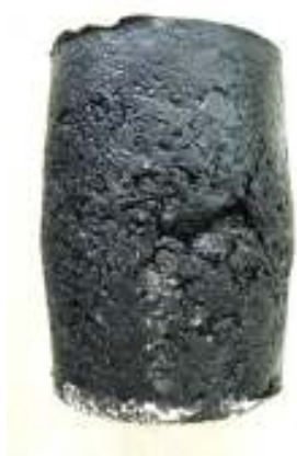
ตัวอย่างแอสฟัลติกคอนกรีต AC40/50 อุณหภูมิ 25°C อัตราความเครียด = 0.0006 ต่อวินาที
