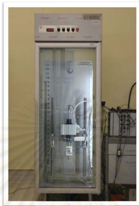
รูปที่ 3.5 เครื่องมือทดสอบ Universal Testing Machine (Controls UTM-14 kN)
