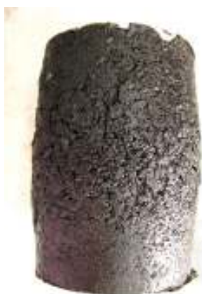
ตัวอย่างแอสฟัลติกคอนกรีต AC80/100 อุณหภูมิ 55°C อัตราความเครียด = 0.0017 ต่อวินาที
