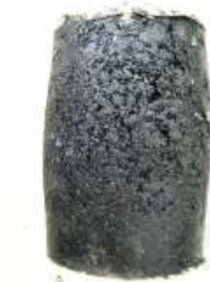
ตัวอย่างแอสฟัลติกคอนกรีต AC60/70 อุณหภูมิ 25°C อัตราความเครียด = 0.0167 ต่อวินาที
