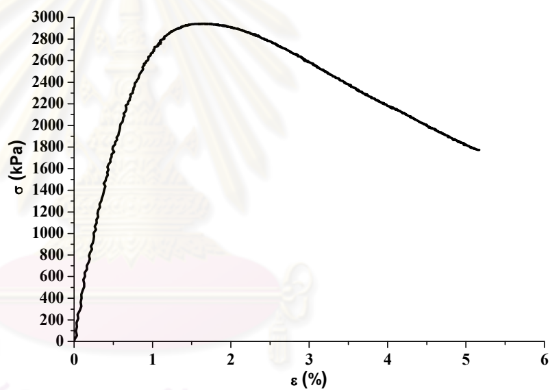
ตัวอย่างแอสฟัลติกคอนกรีต AC60/70 อุณหภูมิ 40°C อัตราความเครียด = 0.0167 ต่อวินาที
