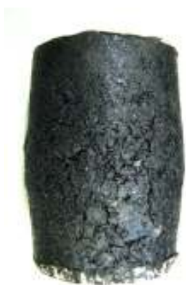
ตัวอย่างแอสฟัลติกคอนกรีต AC60/70 อุณหภูมิ 40°C อัตราความเครียด = 0.0056 ต่อวินาที
