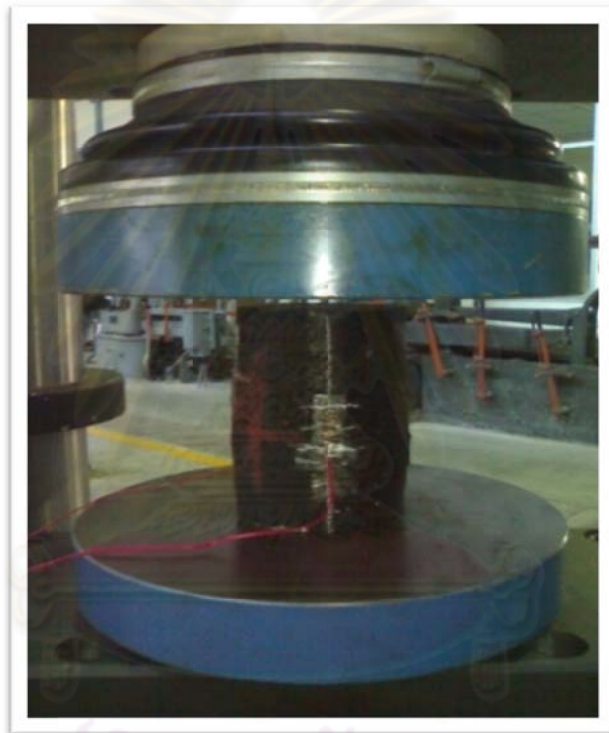
รูปที่ 3.8 รูปแบบการติดตั้งอุปกรณ์การทดสอบ แรงอัดแบบปราศจากแรงดันด้านข้างแบบสถิต
