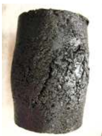
ตัวอย่างแอสฟัลติกคอนกรีต AC40/50 อุณหภูมิ 55°C อัตราความเครียด = 0.0006 ต่อวินาที
