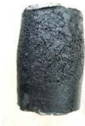
ตัวอย่างแอสฟัลติกคอนกรีต AC40/50 อุณหภูมิ 25°C อัตราความเครียด = 0.0167 ต่อวินาที
