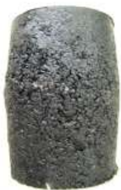
ตัวอย่างแอสฟัลติกคอนกรีต AC80/100 อุณหภูมิ 25°C อัตราความเครียด = 0.0006 ต่อวินาที
