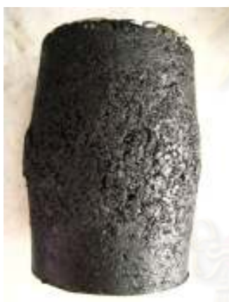
ตัวอย่างแอสฟัลติกคอนกรีต AC60/70 อุณหภูมิ 55°C อัตราความเครียด = 0.0167 ต่อวินาที
