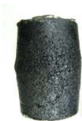
ตัวอย่างแอสฟัลติกคอนกรีต AC60/70 อุณหภูมิ 40°C อัตราความเครียด = 0.0167 ต่อวินาที
