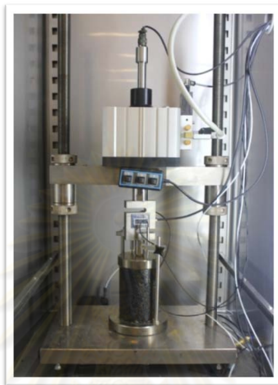
รูปที่ 3.9 รูปแบบการติดตั้งอุปกรณ์การทดสอบ แรงอัดแบบปราศจากแรงดันด้านข้างแบบพลวัต
