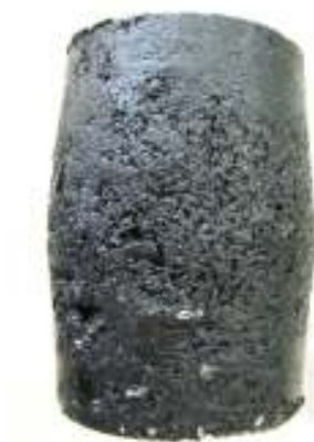
ตัวอย่างแอสฟัลติกคอนกรีต AC40/50 อุณหภูมิ 25°C อัตราความเครียด = 0.0017 ต่อวินาที
