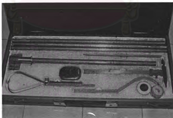
รูปที่ ข. 4 เครื่องมือวัดสัดส่วนร่างกาย (Martin Type Anthropometer)
