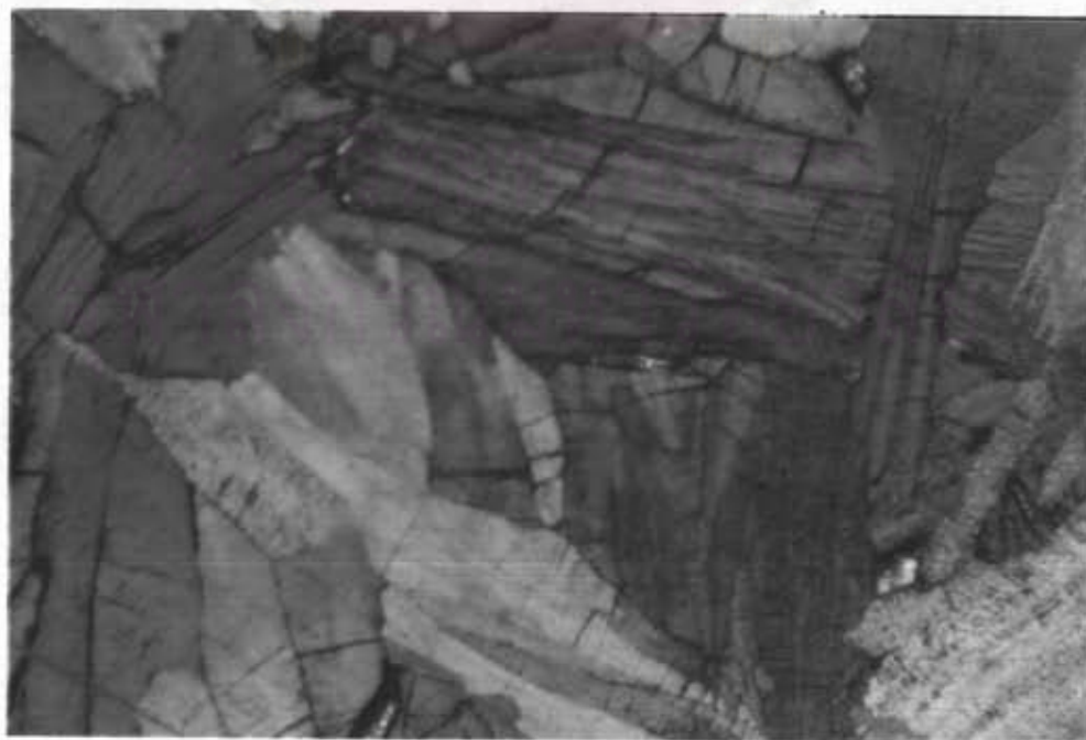
ภาพที่ 3.26 ลักษณะผลึกแท้ของแร่ไนโตรลูไซต์ หลังการ Cross-Nicol (x90)
