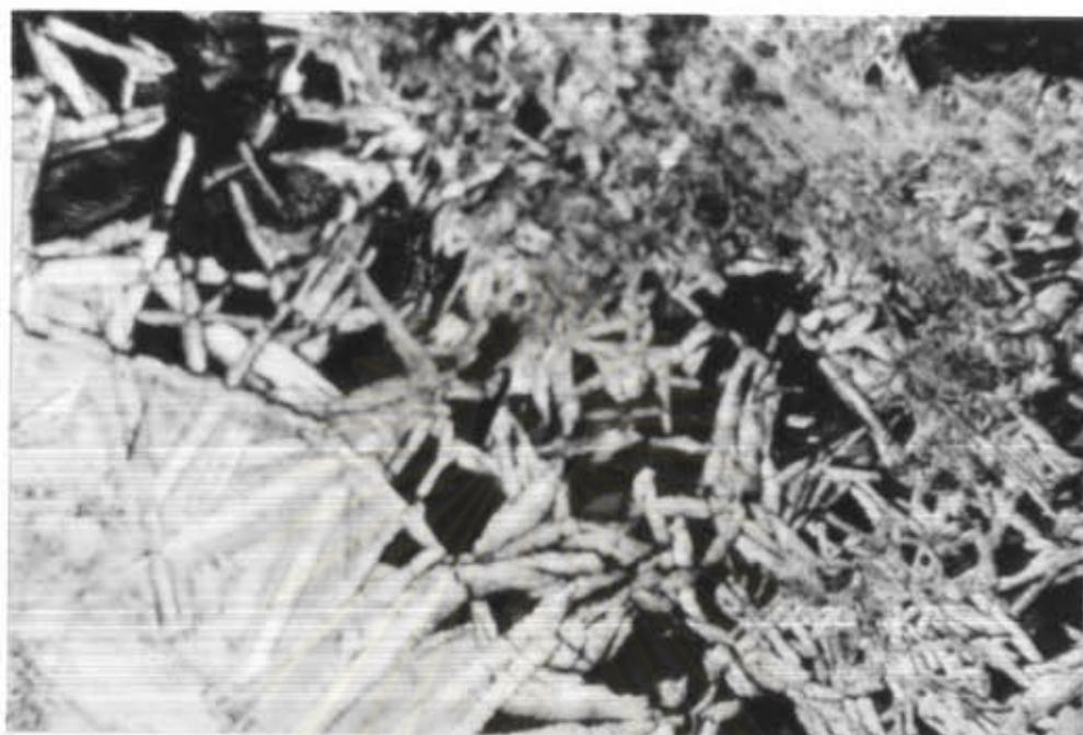
ภาพที่ 3.23 ลักษณะผลึกรูปเข็มของแอมโพลีโพรพิลีน (x90)
