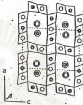
ภาพที่ 2.9 โครงสร้างของแร่ไพโรคลอเรน จุดและวงกลม หมายถึง Mn จุดและวงกลมที่มีวงกลมล้อมรอบ หมายถึง Ba และ H_2O (45)
