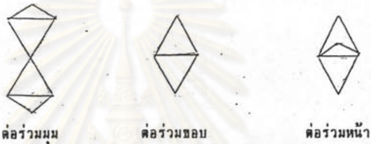
ภาพที่ 2.4 ลักษณะการต่อเชื่อมกันแบบต่างๆของออกตะฮีดรา (44)
