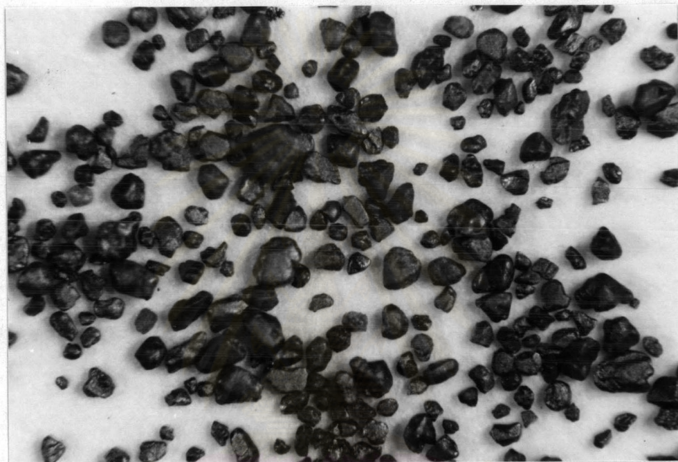
รูปที่ 3.24 แร้อิลเมนไนต์ที่ผ่านการออกซิเดชันด้วยเตาหมุนที่อุณหภูมิ 1000 °ซ. เวลา 4 ชั่วโมง ถ่ายด้วยกล้องสองตา \times 20 (สังเกตได้ว่ามีสีเทา)
