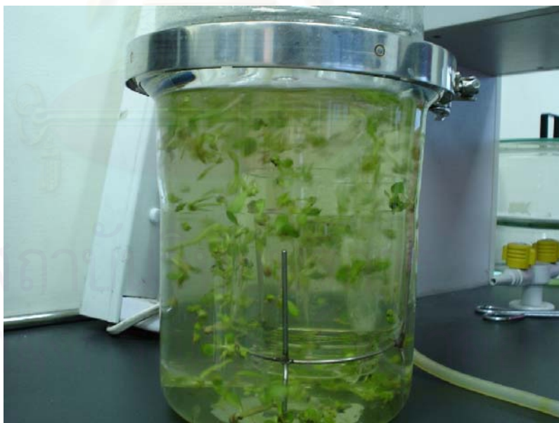
รูปที่ 4.52 ลักษณะของต้นอ่อนขณะเพาะเลี้ยงในเครื่องปฏิกรณ์แบบแอร์ลิปต์โดยใช้แก๊สคาร์บอนไดออกไซด์เป็นตัวพ่นเป็นเวลา 3 สัปดาห์
