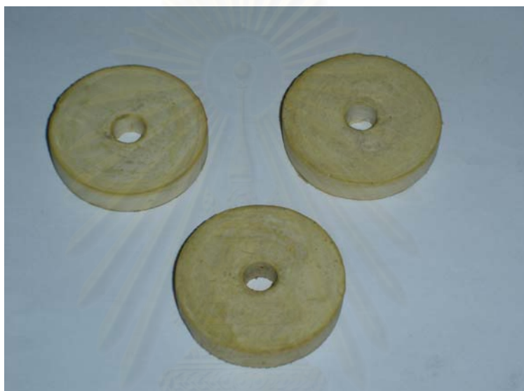
รูปที่ 4.37 ยางรูปวงที่ใช้ในการทดสอบค่าความแข็ง
