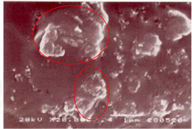
รูปที่ 4.11 ขนาดของอนุภาคอะลูมิเนียมซิลิเกต ความเข้มข้น 30% ของกาวแก้วที่ 50 phr และ pH ของสารส้ม 3.15
