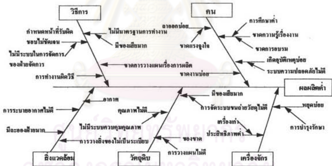
รูปที่ 5.1 แผนภูมิ ก้างปลา แสดงถึงสาเหตุที่ทำให้ผลผลิตในโรงงานอุตสาหกรรมปั่นด้ายต่ำลง
