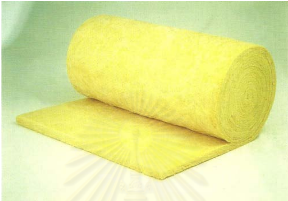
ภาพที่ 2.9 ลักษณะของฉนวนใยแก้วแบบคลุมห่ม ไม่มีฟอยล์ ใช้งานโดยการปูหรือบุที่ผนังหรือเพดาน การใช้งานควรห่มห่อด้วยวัสดุที่กันความชื้นได้ดี (สุนทร บุญญาธิการ, 2543)
