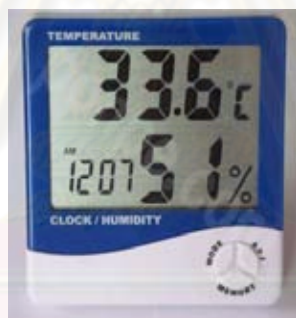
ภาพที่ 3.10 แสดงเครื่องวัดอุณหภูมิและความชื้น
