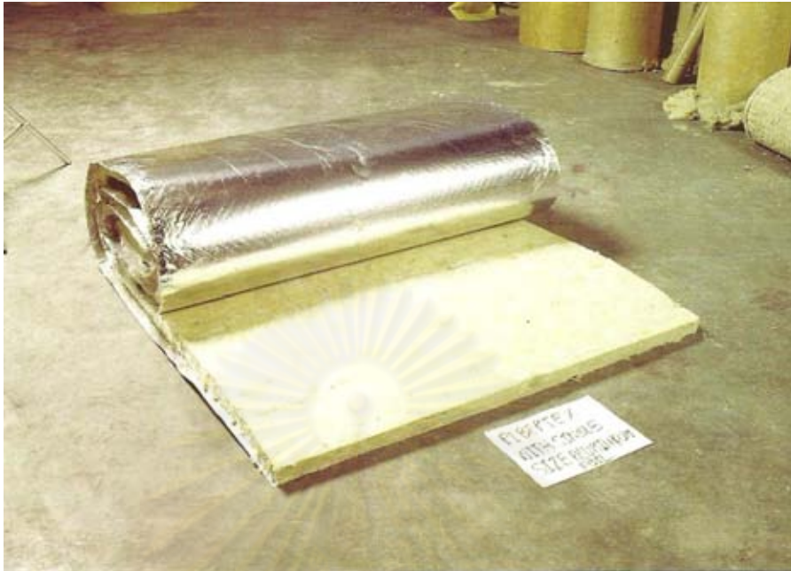
ภาพที่ 2.14 ลักษณะของฉนวนใยแร่แบบแผ่นสำหรับก่อสร้าง หรือแบบคลุมห่ม มีฟอยล์หุ้มห่อ เพื่อกันความชื้น ใช้ในส่วนของผนังหรือเพดาน โดยบุไว้ตรงกลางระหว่างผนัง ภายนอกกับภายใน หรือปูลาดบนโครงเคร่าเพดาน (สุนทร บุญญาธิการ, 2543)
