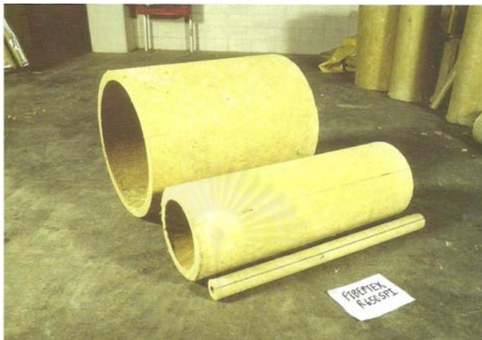
ภาพที่ 2.16 ลักษณะของฉนวนใยแร่แบบหุ้มท่อ มีรูปแบบและการใช้งานเช่นเดียวกับฉนวนใยแก้วแบบหุ้มท่อ (สุนทร บุญญาธิการ, 2543)
