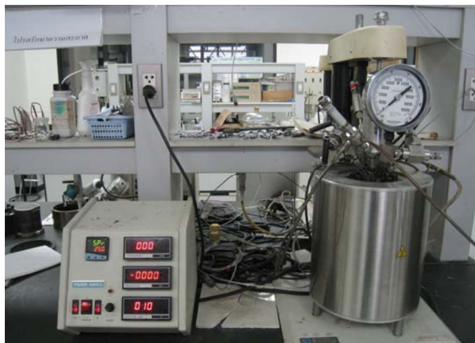
รูปที่ 3.8 การตั้งเครื่องมือในการทำปฏิกิริยาไฮโดรไลซิส
