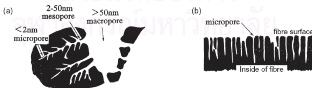
รูปที่ 2.10 ลักษณะรูพรุนของถ่านกัมมันต์ (a) granular (b) fibrous [Manocha, 2003]
