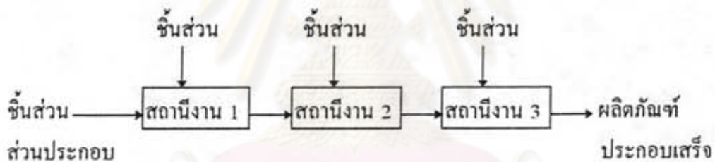
รูปที่ 2.2 แสดงถึงการเคลื่อนย้ายหรือส่งชิ้นส่วนไปตามสถานีงานต่าง ๆ
