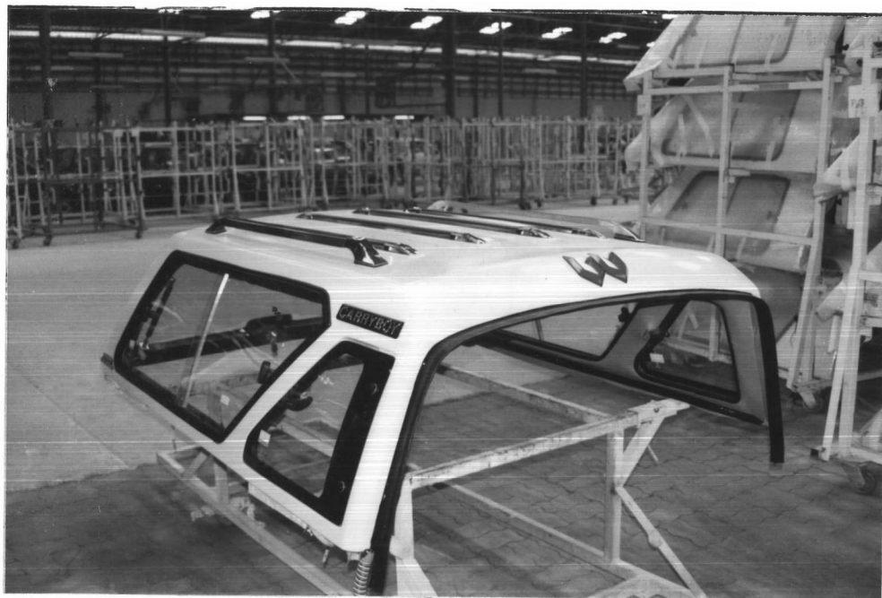
รูปที่ 1.1 หลังคาไฟเบอร์กลาส
