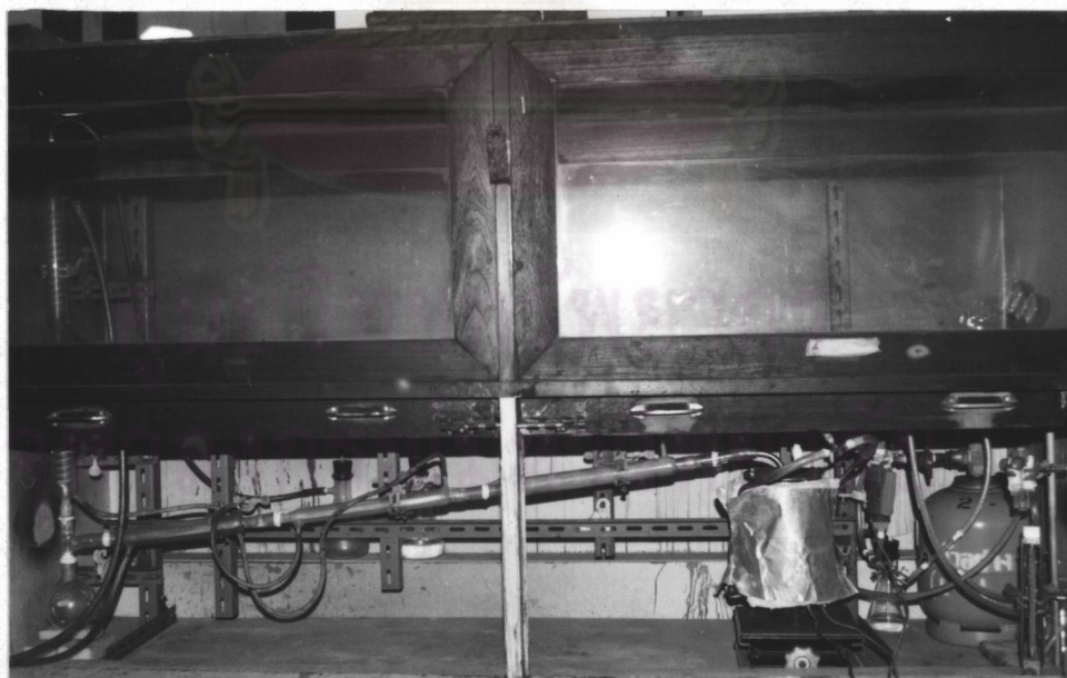
รูปที่ 3.4 ชุดทดลองผลิตทิน(IV)คลอไรด์
