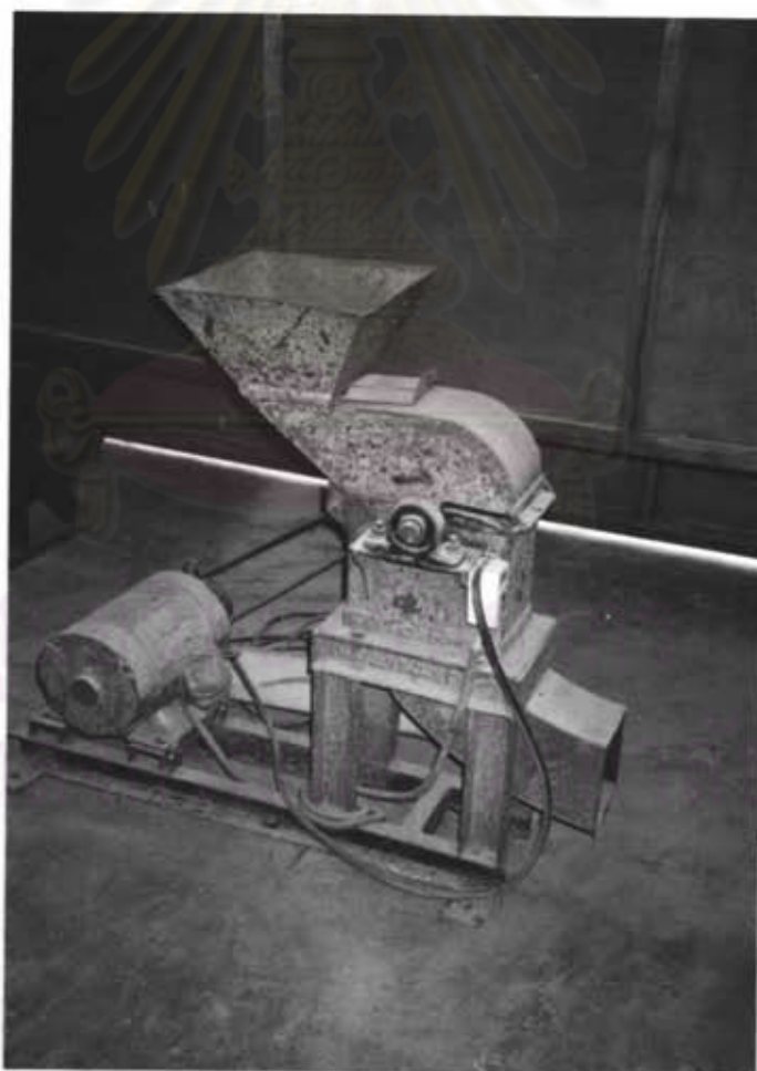
ภาพที่ 3.1 เครื่องบดถ่านหินชนิด hammer mill
