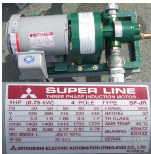
ภาพที่ 3.9 ปั๊มน้ำมันร้อนยี่ห้อ มิตซูบิชิ รุ่น SF-JR
