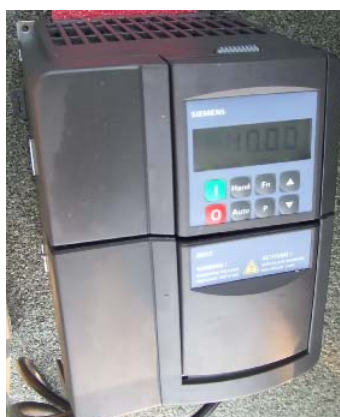
ภาพที่ 3.10 Variable Frequency Drive (VFD) ยี่ห้อ SIEMENS รุ่น SED2
