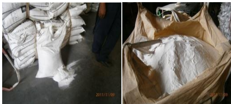
ภาพที่ 2.11 เกลือโซเดียมซัลเฟตที่ปนเปื้อนสิ่งสกปรก (ที่มา: บริษัทไทยเรยอน จำกัด (มหาชน), 2554)
