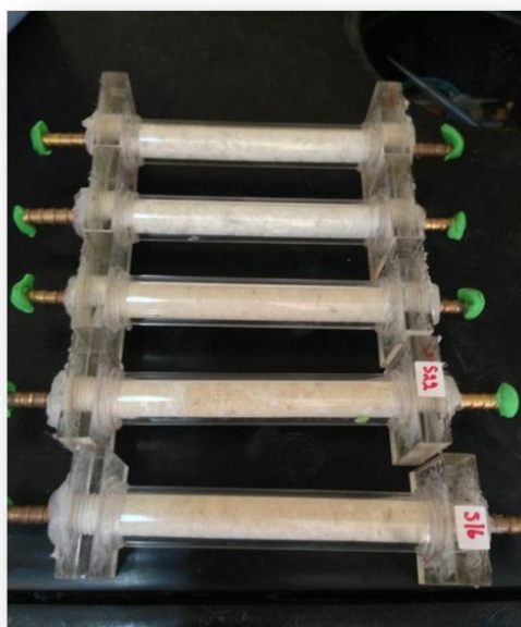
ภาพที่ จ.1 แผ่นกรองคาร์บอน ปริมาณ 2 กรัม ที่บรรจุในคอลัมน์ดูดซับ
