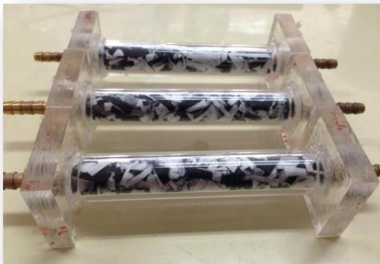
ภาพที่ จ.1 แผ่นกรองคาร์บอน ปริมาณ 2 กรัม ที่บรรจุในคอลัมน์ดูดซับ
