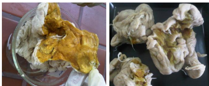
ภาพที่ 4.1 ตัวอย่างของวัสดุคูดซัซที่มีการขึ้นรูปไม่สมบูรณ์
