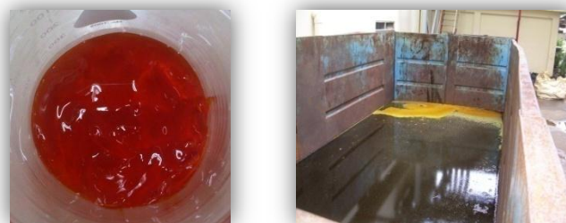
ภาพที่ 2.10 สารละลายหนืดหรือวิสโคส (ที่มา: บริษัทไทยเรยอน จำกัด (มหาชน), 2554)
