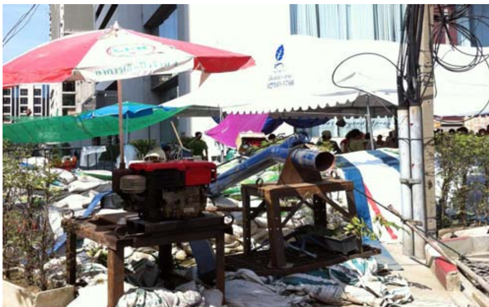
รูปที่ 3.20 เครื่องสูบน้ำชนิดเครื่องยนต์ที่สูบน้ำขนาด 6 นิ้ว
