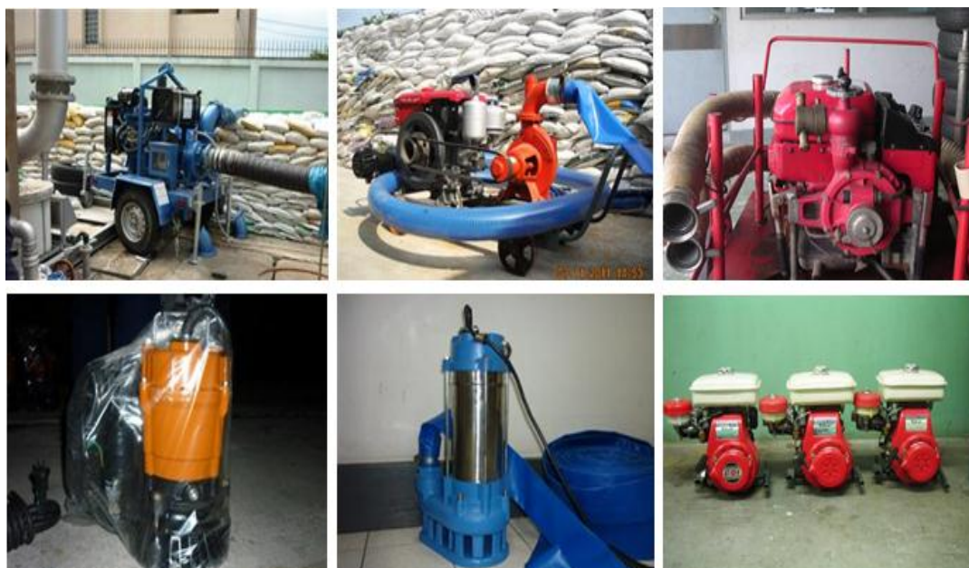
รูปที่ 3.67 เครื่องสูบน้ำเสริม หลังแนวกัน
