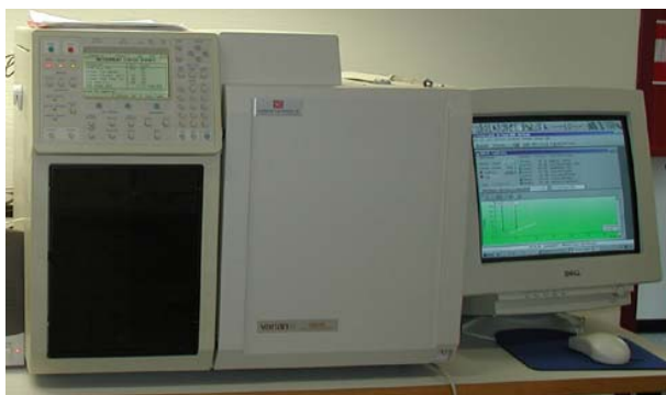
รูปที่ 3.2 เครื่องมือก๊าซโครมาโทกราฟีที่ใช้งานวิจัยนี้
