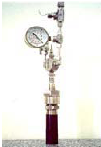
ภาพที่ 3.1 เครื่องปฏิกรณ์ขนาดเล็กที่มีปริมาตร 250 มิลลิลิตร (Micro-reactor)
