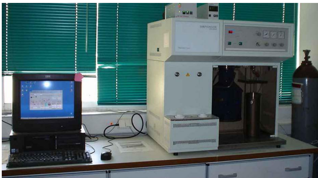
ภาพที่ 3.7 เครื่องหาพื้นที่ผิวรูพรุนทั้งหมด (BET surface area)
