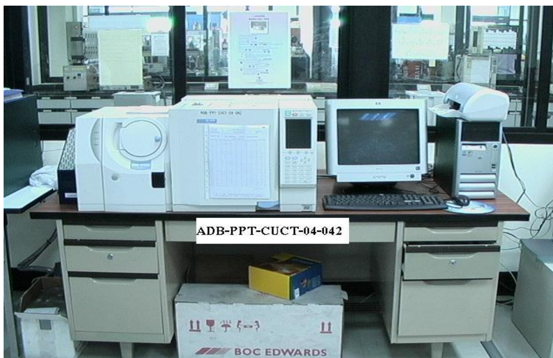
ภาพที่ 3.9 เครื่อง Gas Chromatography-Mass Spectrometry (GC-MS) รุ่น A SHIMADZU GC-MS QP2010
